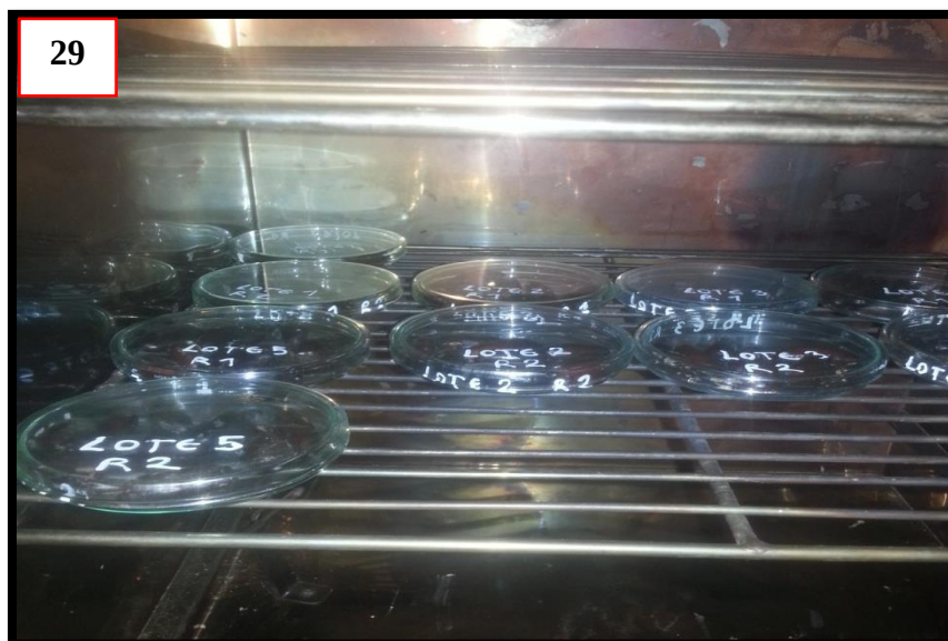
Fotografía 29: Placas Petri con muestras de semillas llevadas a la estufa a una temperatura de 103 grados centígrados por un periodo de tiempo de 18 horas para poder determinar el peso seco y calcular el contenido de humedad
