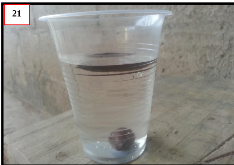
Fotografía 21: Recipiente con una muestra de semilla vana (flotando) y una semilla acta para el ensayo (hundida)
