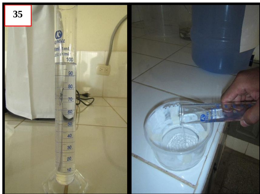
Fotografía 35: Añadiendo 100 ml de agua oxigenada dentro de las cámaras de envejecimiento
