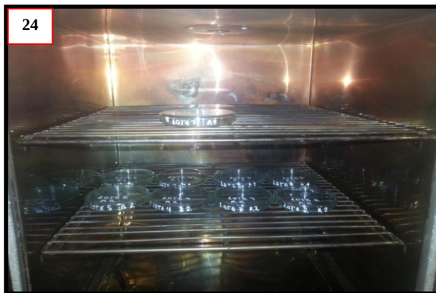
Fotografía 24: Placas Petri vacías colocadas en una estufa para empezar a tomar los datos del contenido de humedad de las semillas
