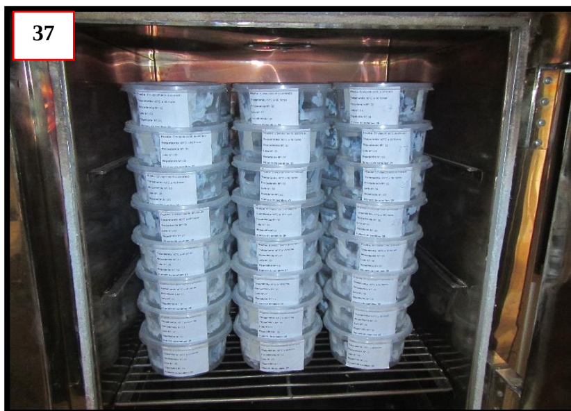
Fotografía 37: Cámaras de envejecimiento acelerado etiquetadas y codificadas llevadas al horno para cumplir con los siguientes tratamientos (40° C a 48 Horas y 40°C a 96 horas)
