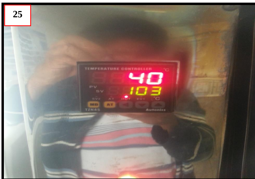
Fotografía 25: Programación de la estufa a una temperatura de 130 grados centígrados por un periodo de una hora, esto para semillas que presentan características de ser oleaginosas (semillas aceitosas)
