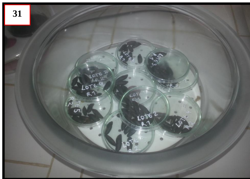
Fotografía 31: Muestras ya secadas colocados en un desecador por un periodo de 45 minutos para posteriormente ser pesadas
