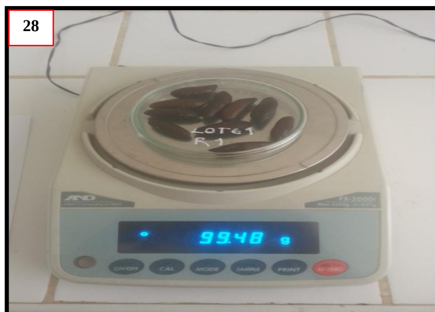
Fotografía 28: Peso de las Placas Petri con la muestra de 10 semillas por cada una de las 2 repeticiones por lote (Peso húmedo de las muestras)
