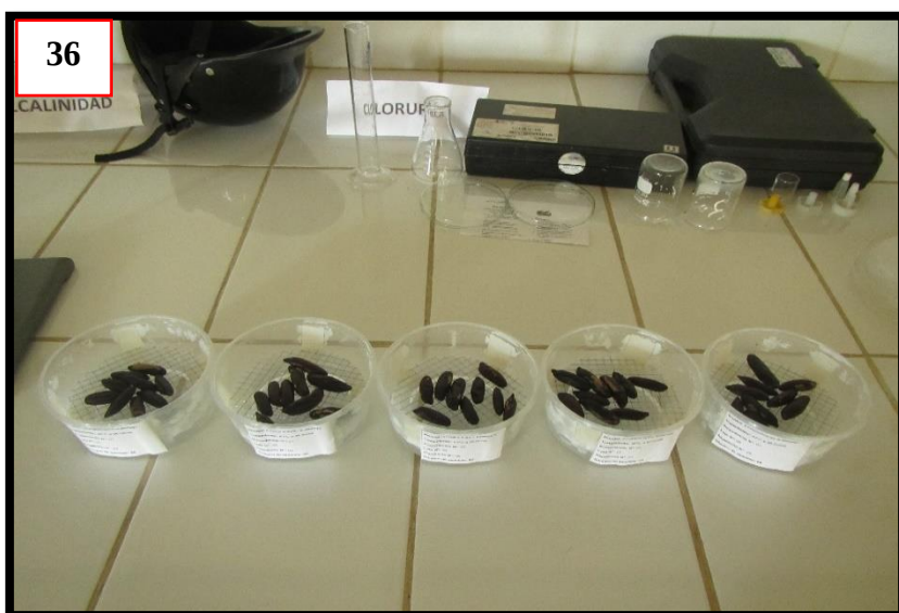
Fotografía 36: Semillas colocadas en las cámaras de envejecimiento acelerado para ser llevadas al horno para cumplir con los siguientes tratamientos (40° C a 48 Horas y 40° C a 96 horas)
