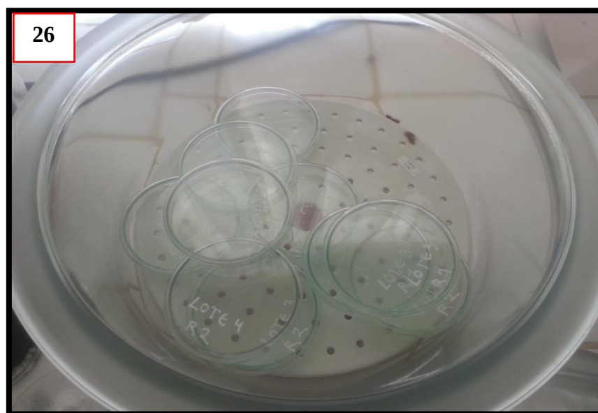
Fotografía 26: Placas Petri después de ser sometidas en la estufa a una temperatura de 130 grados centígrados por una hora colocada en un desecador por un periodo de una hora
