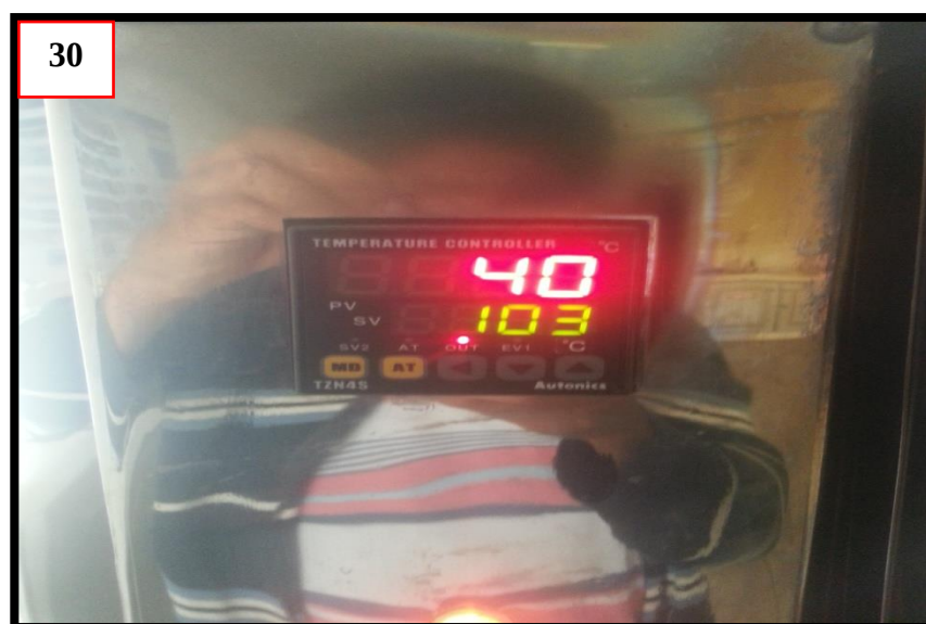
Fotografía 30: Programación de la estufa a una temperatura de 103 grados centígrados por un periodo de 18 horas, esto para calcular el peso seco de las semillas
