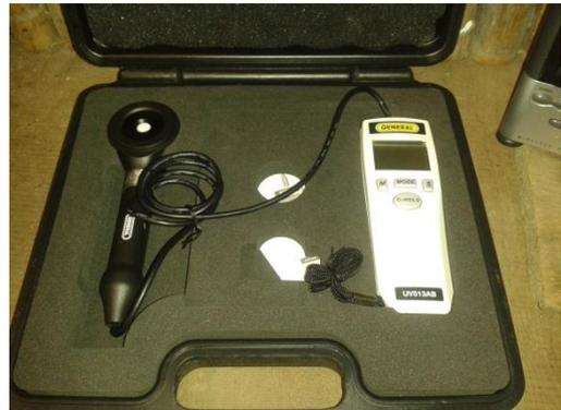
**Medidor de Radiación UV**
