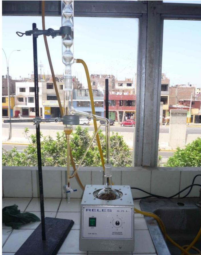
Figura 4. Equipo de destilación con una trampa clewenger. La fuente de calor la proporciona la manta eléctrica.
